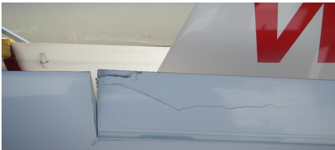
Obr. č. 4: Spodní strana levého křídélka kluzáku WT
