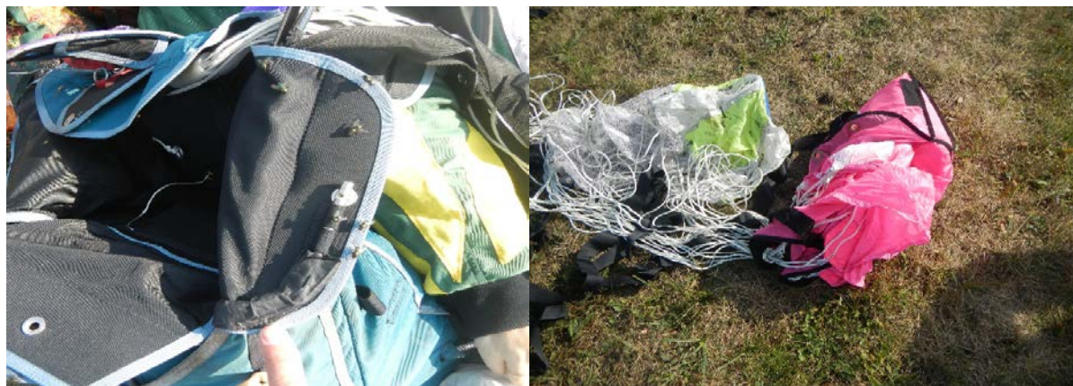
Obr. č. 2: Stav padákového kompletu po nárazu do země
