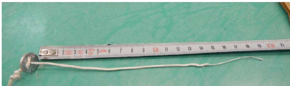
Obr. č. 3: Uzavírací šňůrka záložního padáku s vytrženým očkem
