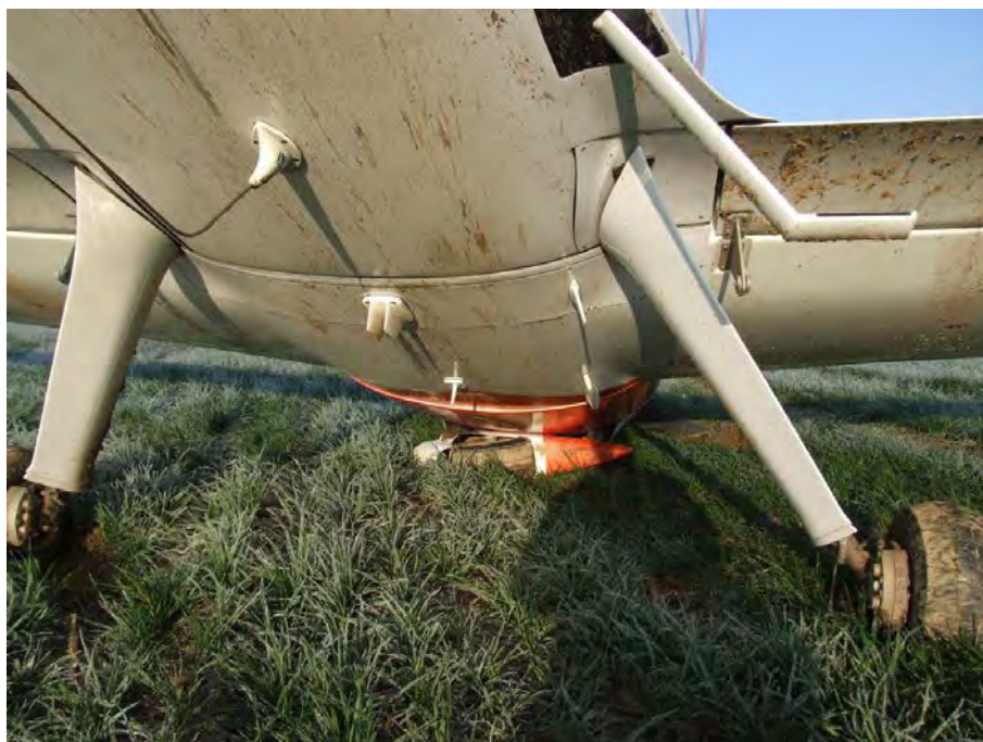
Obr. 3 Zalomená přední podvozková noha pod spodním motorovým krytem
