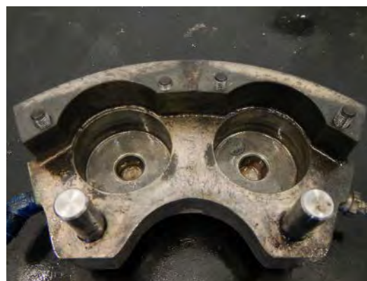
Kontrola funkčnosti brzd včetně brzdíčů po provedené demontáži obou kol z letounu,
