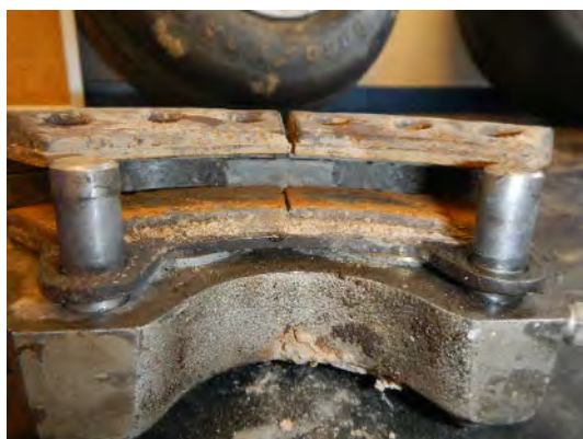
Kontrola funkčnosti brzd včetně brzdíčů po provedené demontáži obou kol z letounu,
