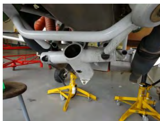
Poškození motorového lože, vylomení uchycení předového podvozku
