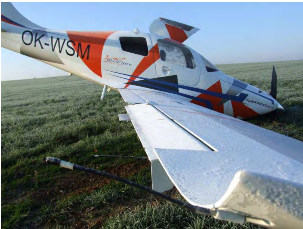
Obr. 5: Námraza typu jinovatka na povrchu letounu a poloha zasunutých klapek
