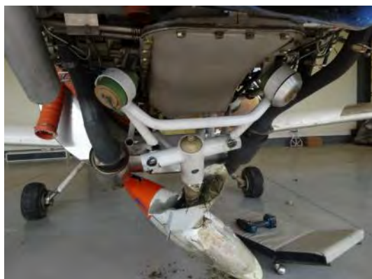
Poškození motorového lože, vylomení uchycení předového podvozku
