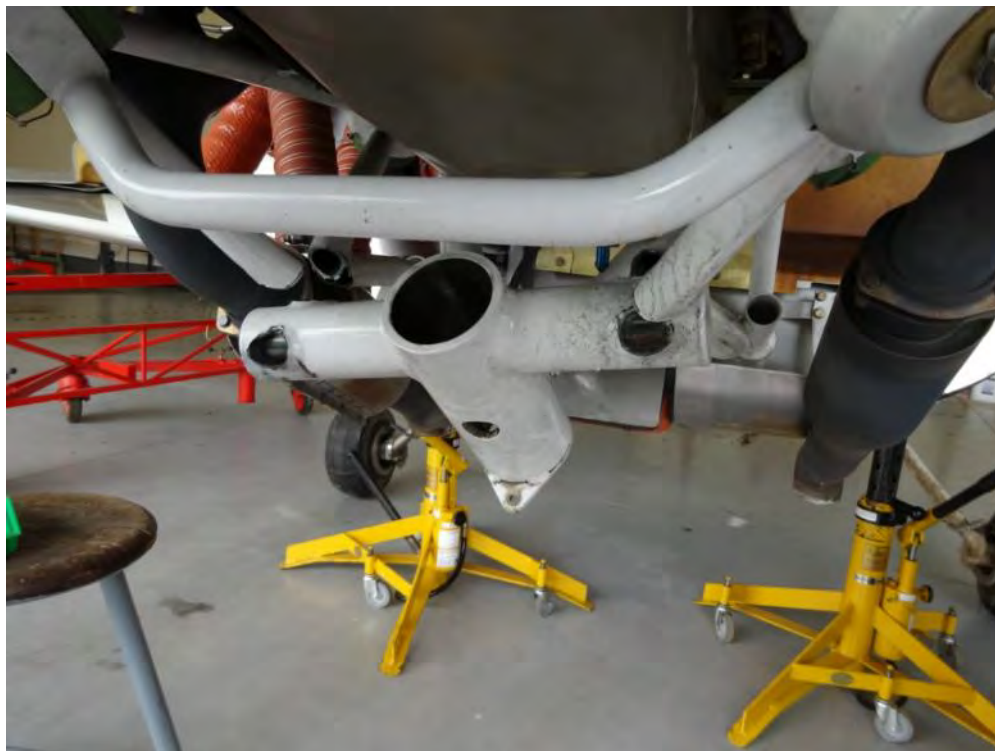
Obr. 4: Poškození motorového lože, vylomení uchycení předového podvozku
