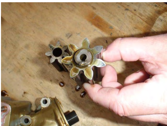
Lom hřídele a stav ozubení hnacího kola olejového čerpadla
