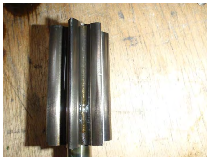
Lom hřídele a stav ozubení hnacího kola olejového čerpadla
