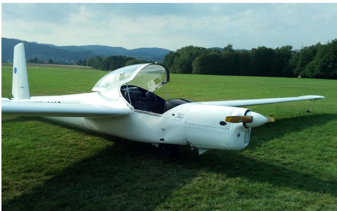
Obr. 1 – celkový pohled na motorový kluzák se sklopenou podvozkovou nohou a deformací trupu mezi podvozkem a motorovou přepážkou.
