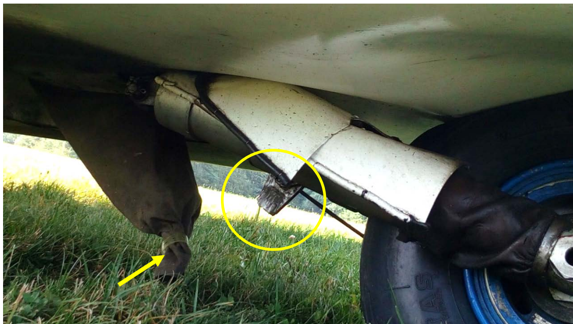
Obr. 2 – na snímku je prasklá vzpěra a vpravo je dopředu sklopený podvozek.
