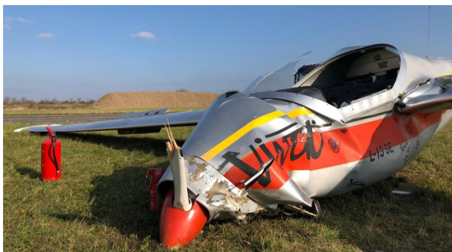
Obr. 2 Deformace přídě, kabiny a křídla.
