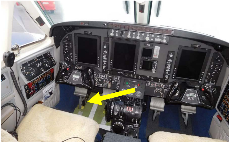
Obr. 4 – Pilotní kabina D-ICMK. Místo odkud se šířil dým (žlutá šipka).
