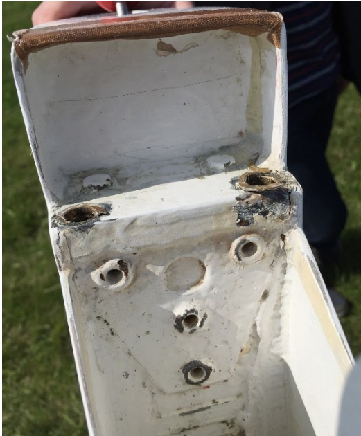
Obrázek č. 2 Poškozená pouzdra závěsu vodorovné ocasní plochy.
