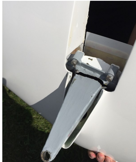
Obrázek č. 3 Zlomené upevňovací kování vodorovné ocasní plochy.
