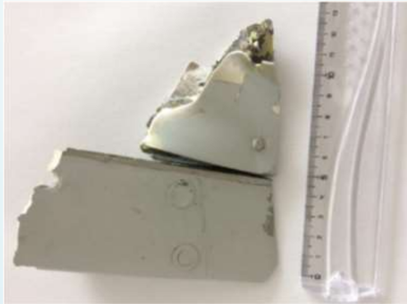
Odseknutý okraj stabilizátoru prvního B 737-800
