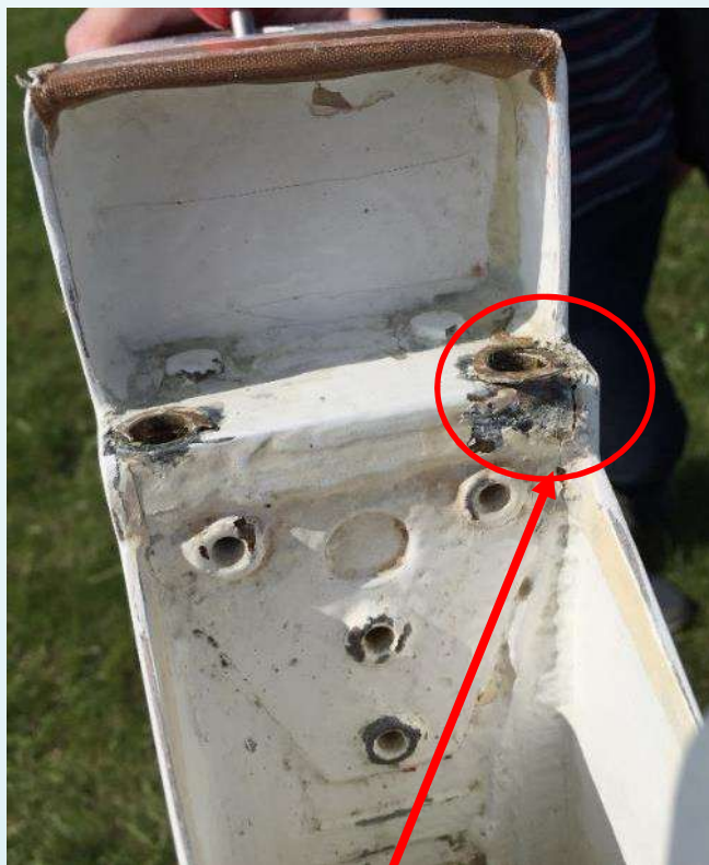
Poškození pouzdra závěsu vodorovné ocasní plochy
