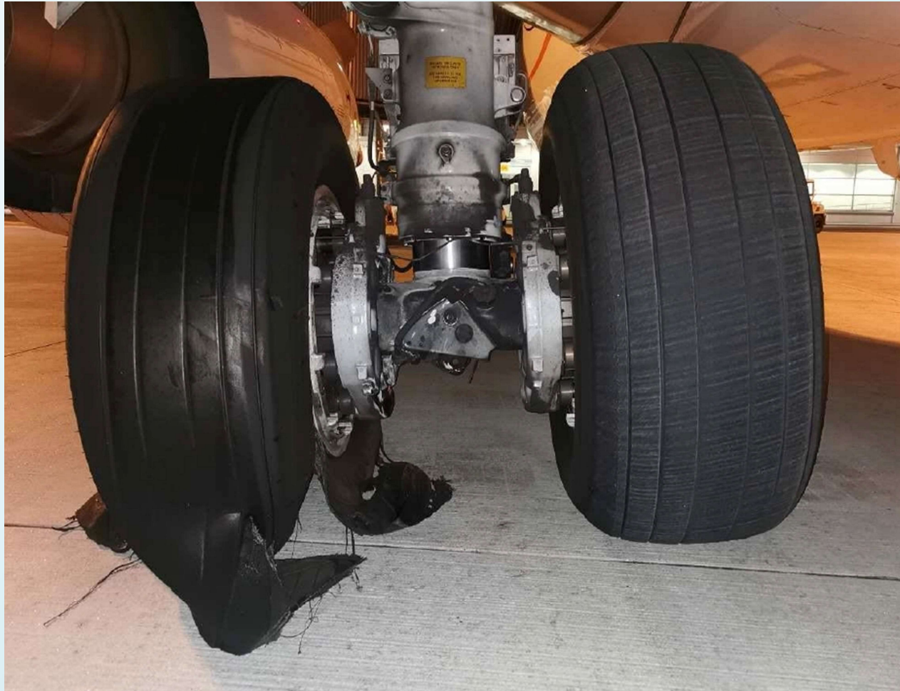
Zničená levá vnější pneumatika hlavního podvozku letounu B 737 po přistání na LKPR
