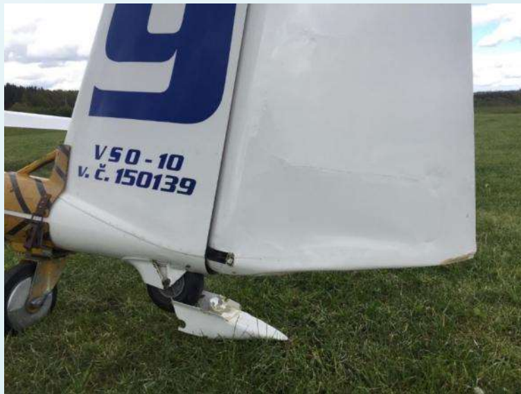
Poškození na VSO-10
