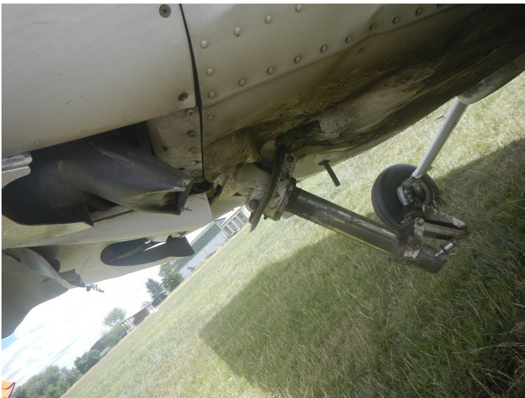
Obr. 9 – Vylomená přední noha s chybějící vidlicí a předním kolem
