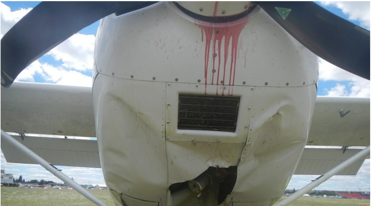
Obr. 10 – Poškozená přední část trupu. Z pod kapotáže pod vrtulí uniká hydraulický olej
