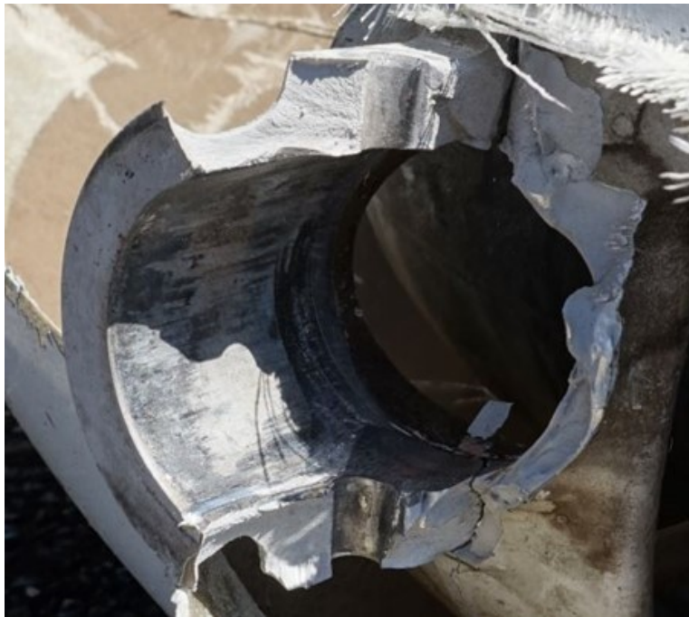
Obr. 1 – Plochy lomu horní části vidlice
