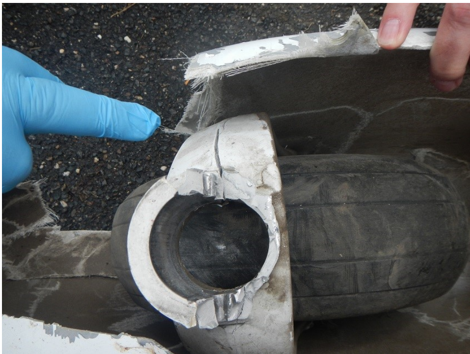
Obr. 11 – Horní část vidlice. Uvnitř válcové části je otlaková stopa od pístnice tlumiče. V rovině osy upevňovacího šroubu je vidět prasklina třmenu vidlice
