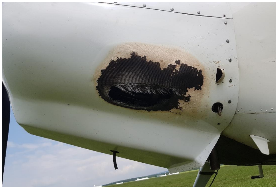
Obr. 2: Motorový kryt poškozený výfukovými plyny.
