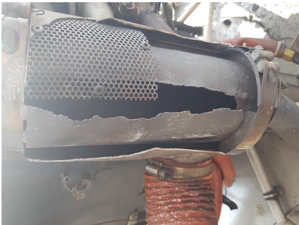
Obr. 4: Poškozený plášť výfuku s poškozeným tepelným výměníkem.
