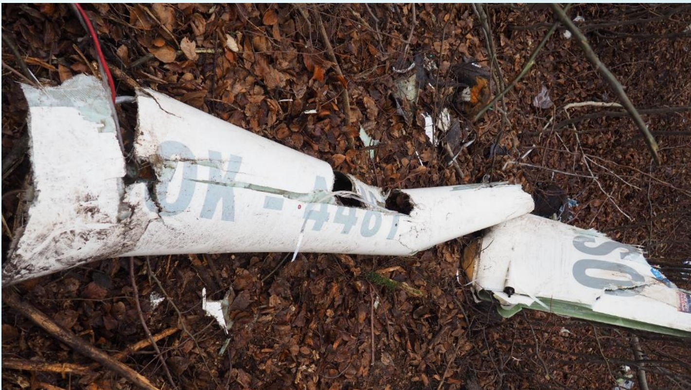
Torzo zadní části trupu ASW 19 na místě nárazu na zem
