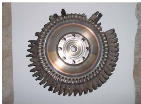
obr.1 Poškození rotoru GT
