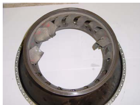
obr. 2 Poškození rozvaděče VT
