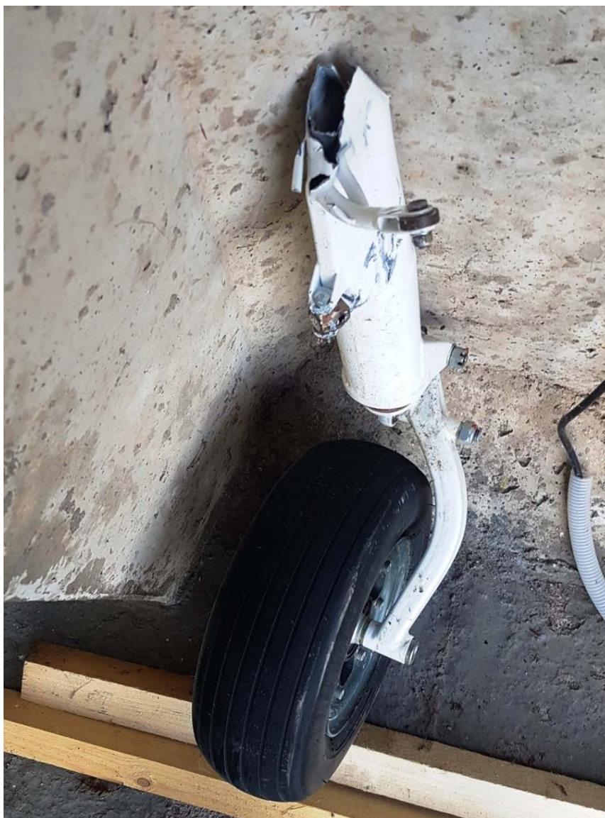
Obr. 2: Spodní část zlomené stojiny přední podvozkové nohy s kolem.
