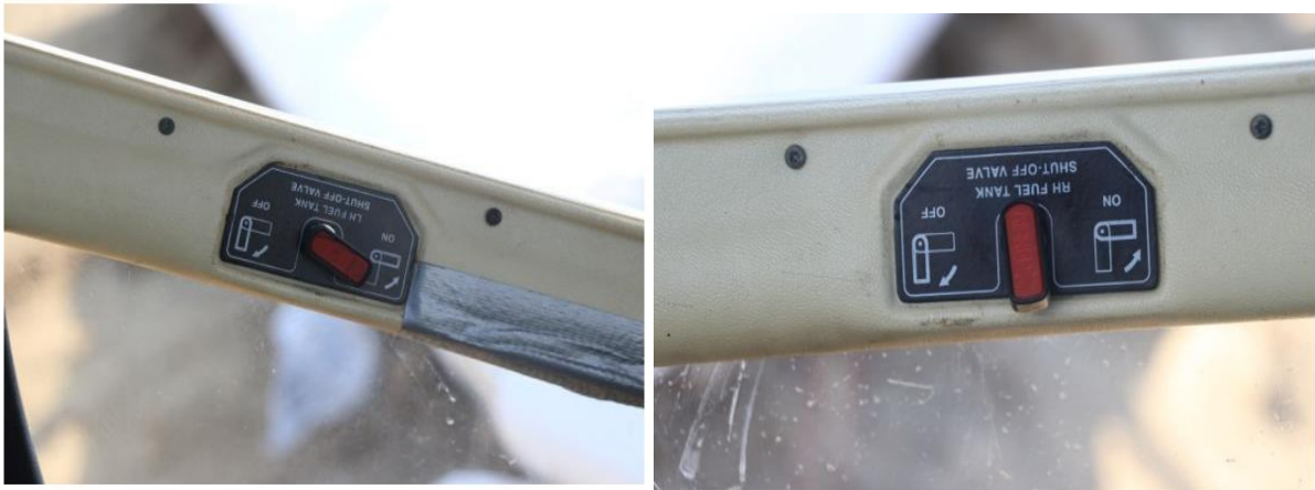
Obr. 6 – Poloha palivových kohoutů po nouzovém přistání (levý ON, pravý OFF)
