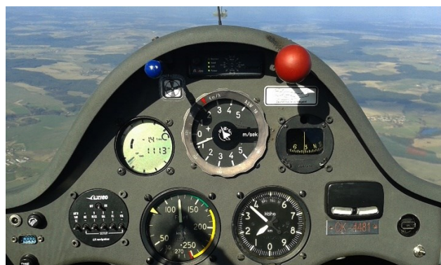
Obrázek č. 6 Palubní deska a letové přístroje. Na rychloměru jsou barevně (výšečí) označena provozní omezení z hlediska maximální přípustné rychlosti letu do nadmořské výšky 3 000 m.
