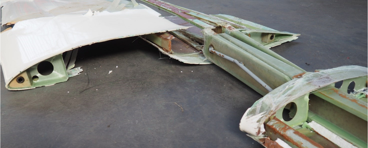
Obrázek č. 13. Pohled na spoj polovin křídla sestavený z nalezených trosek.
