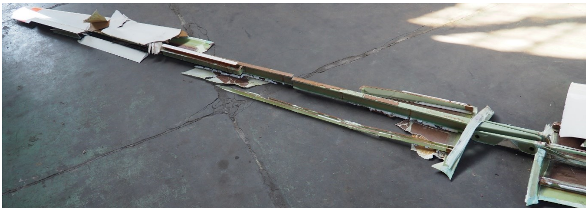
Obrázek č. 12. Rekonstrukce tvaru levé poloviny křídla z nalezených trosek
