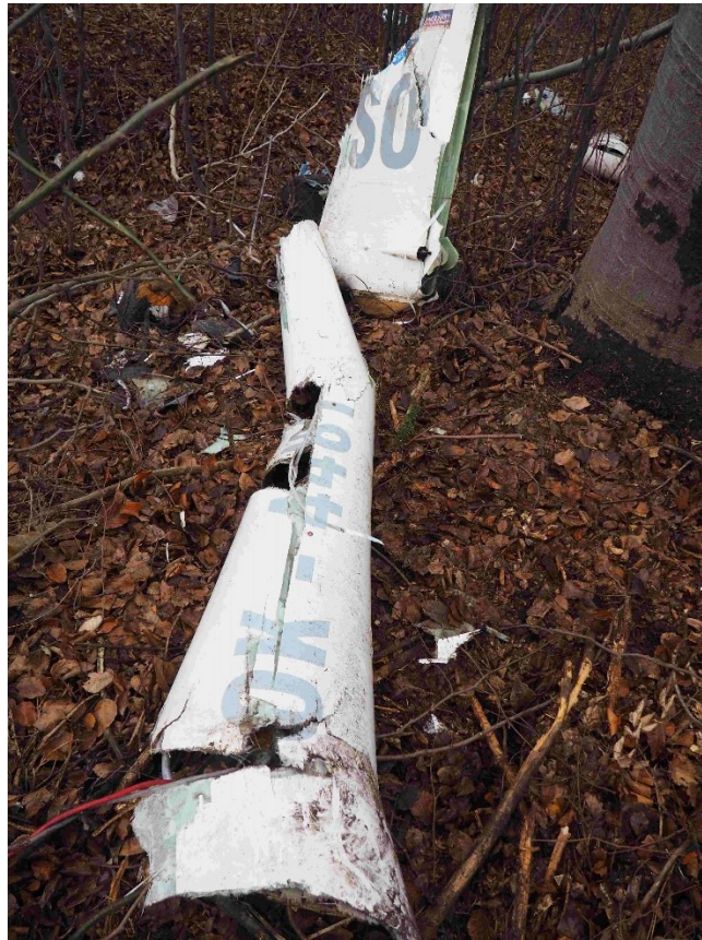
Obrázek č. 9. Trosky levé poloviny zadní části trupu a kýlové plochy
