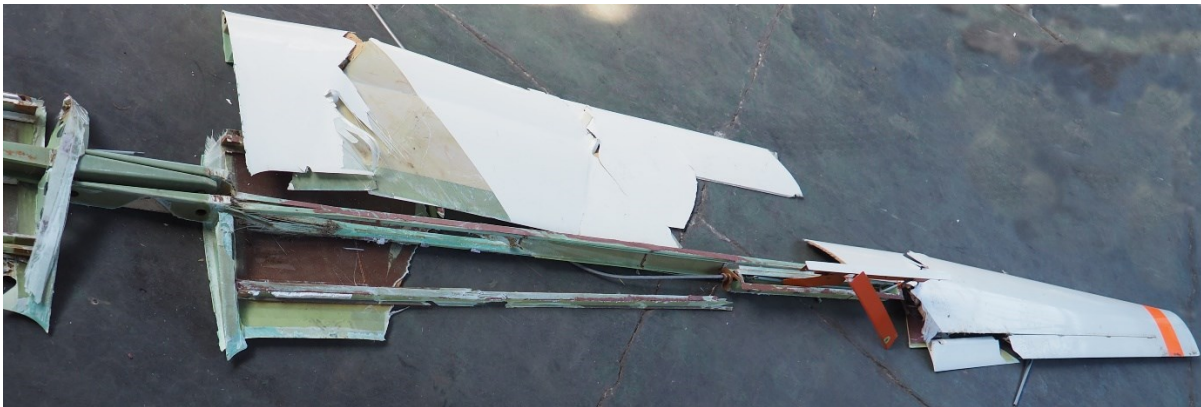
Obrázek č. 11. Rekonstrukce tvaru pravé poloviny křídla z nalezených trosek
