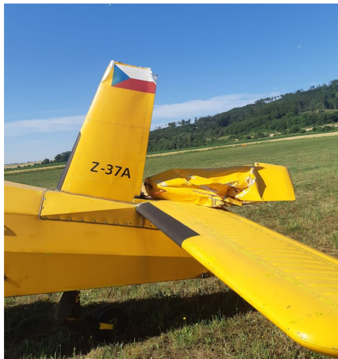
Obr. 9 - Poškození ocasních ploch
