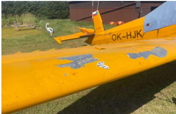
Obr. 10 - Poškození horní plochy pravé poloviny křídla
