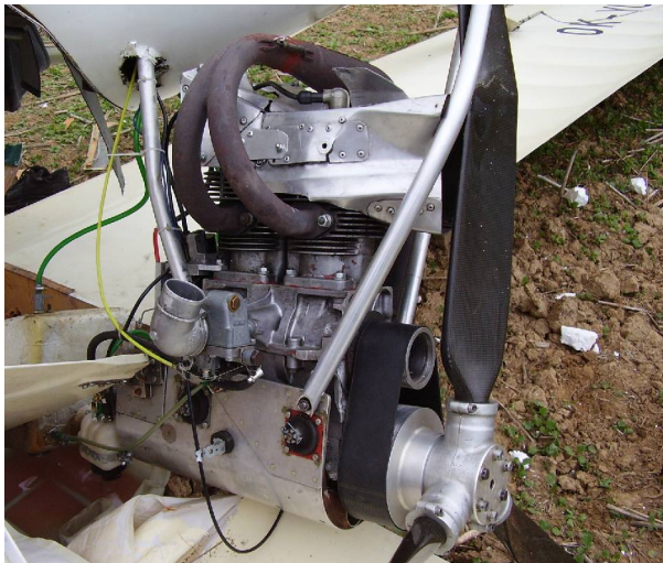
Stav pohonné jednotky po letecké nehodě a přidřený válec č. 2
