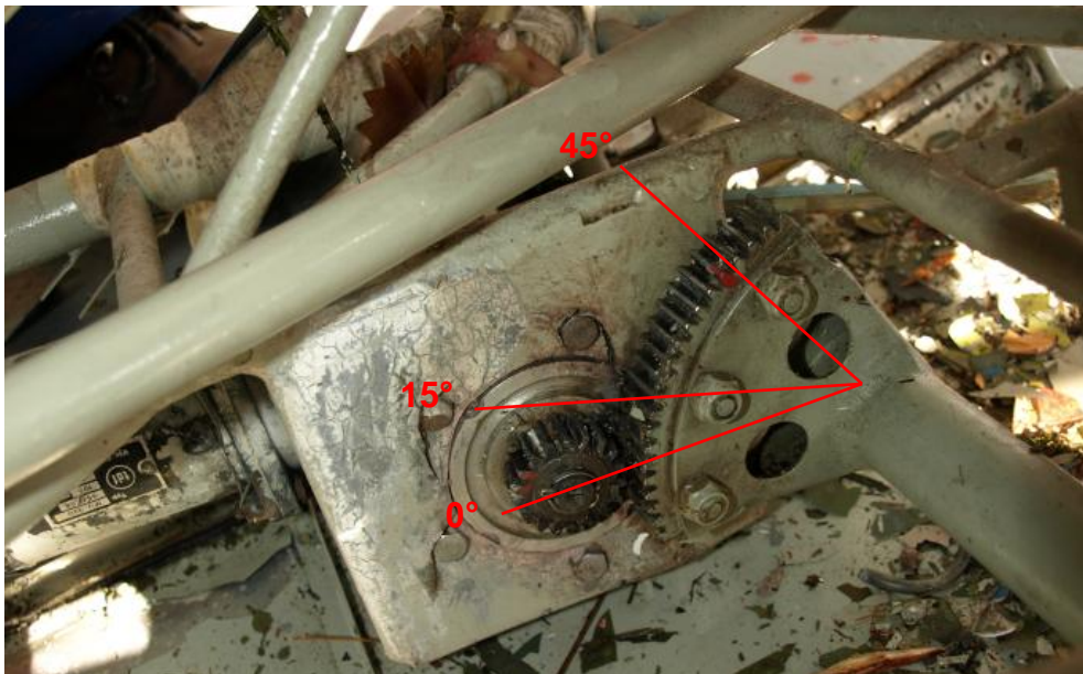
Schéma mechanismu nastavení polohy vztlakových klapek 0°-zasunuto, 15°-vzlet, 45°-plné klapky a zaznamenaná poloha po nárazu 0°-zasunuto.
