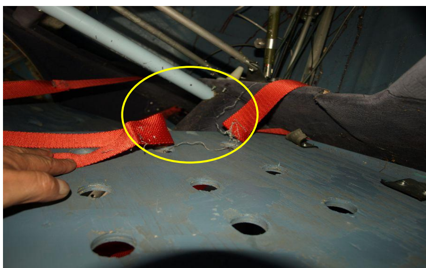
Přetržený bezpečnostní pás levého sedadla a volné opěradlo.
