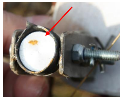
... vložka z Al slitiny vložená do ocelové trubky
