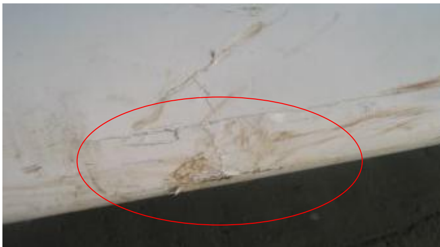
Poškození náběžné hrany pravé poloviny křídla
