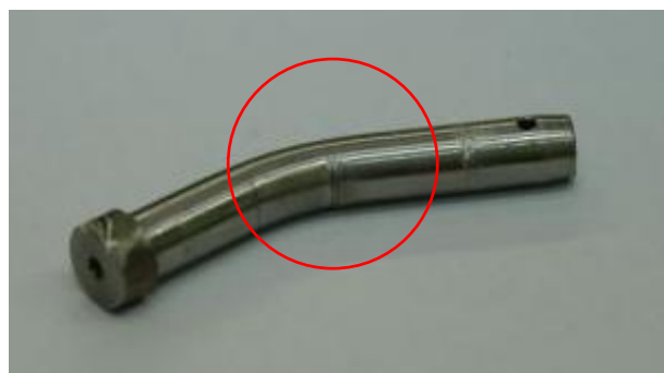
Maximální dosažené zatížení spoje pro ustřížení závlačky a plastická deformace čepu - zkouška ukončena.
