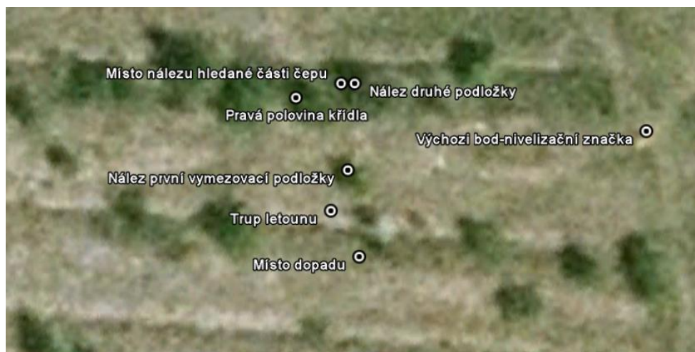
Schéma rozptýlu trosek po dohledání chybějících částí spoje vzpěry pravé poloviny křídla.
