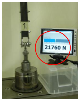
Maximální dosažené zatížení spoje pro ustřížení závlačky a plastická deformace čepu - zkouška ukončena.
