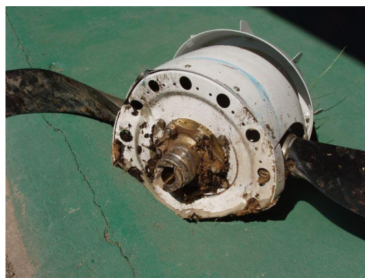
Poškození přední části motoru a poškození vrtule
