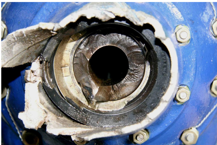
Místo vzniku poruchy klikové hřídele motoru
