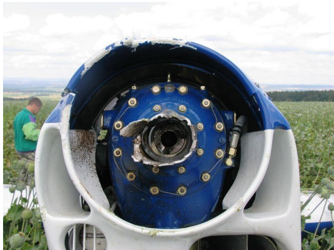
Poškození přední části motoru a poškození vrtule
