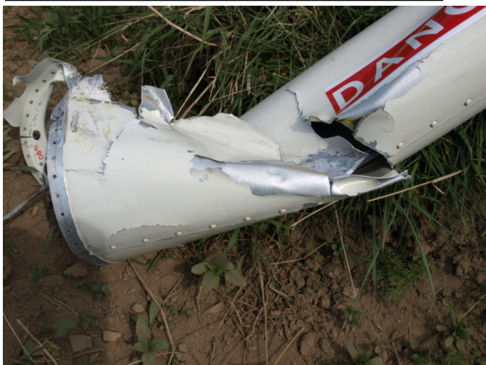
Poškození ocasního nosníku nárazem nosného rotoru
