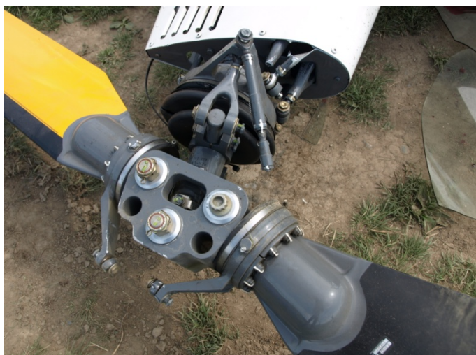
Poškozená hlava a táhla ovládní nosného rotoru
