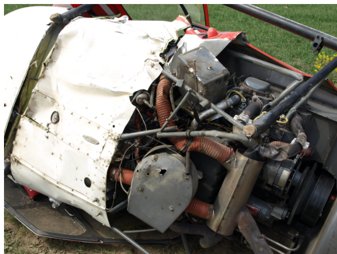
Poškození spodní části trupu a motorového lože
