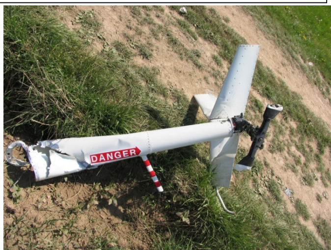
Oddělená část ocasního nosníku a poškozený ocasní rotor
