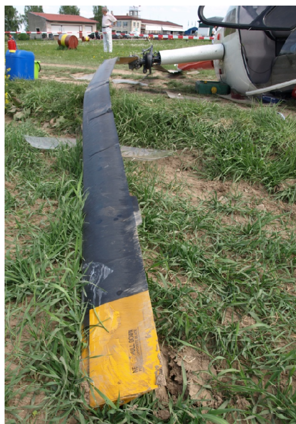
Poškozené listy nosného rotoru
