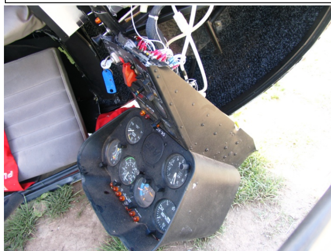
Poškození palubní desky a pultu vylomením
