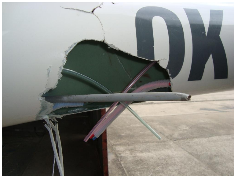
Poškození levé strany trupu
