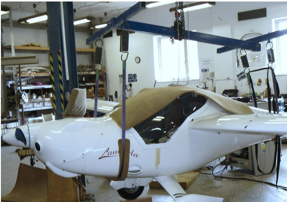
Obr. 2.2 – Zavěšení letounu do pružného závěsu
