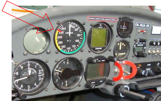
Barevné vyznačení rychlostního omezení SLZ na rychloměru
