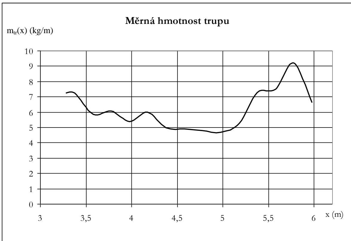
Obr. 2.4 – Měrná hmotnost zadní části trupu
