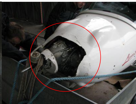
Poškození VOP, motorových krytů a vrtule
