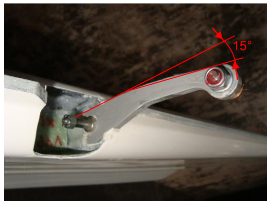
Poškození závěsu a ovládací páky výškového kormidla
