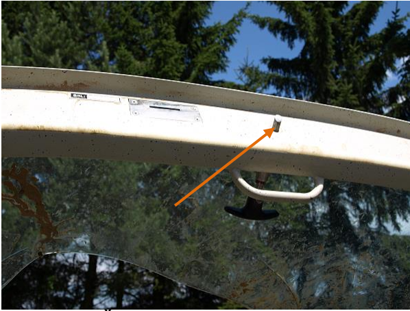
Obr. 4: Čep závěru (délka cca 18 mm) v zajišťovací poloze držený pružinou
