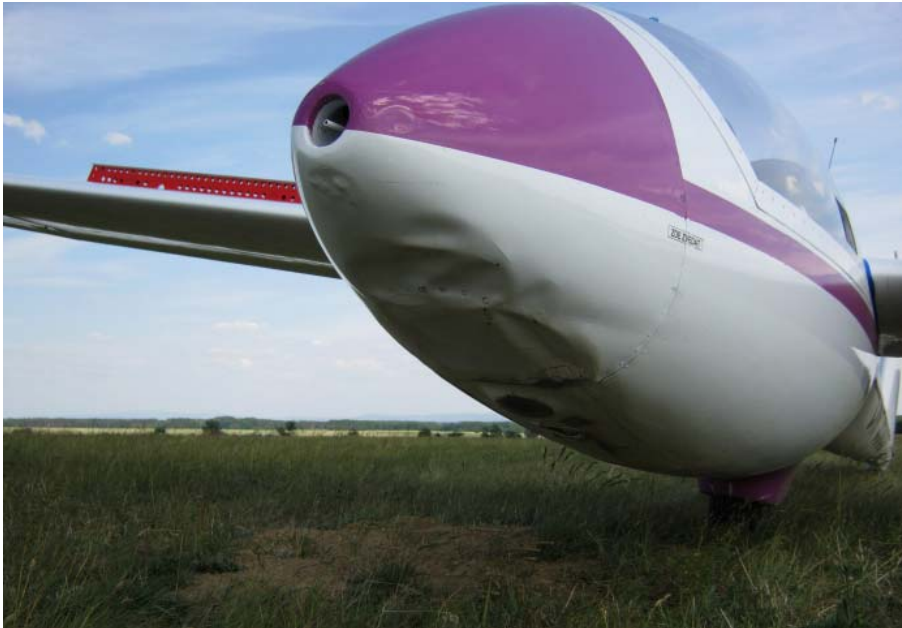
Obr. 1 Poškození přední části
