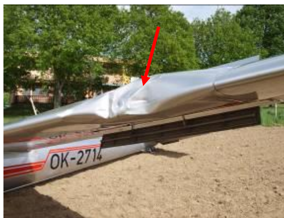
Poškození náběžné hrany levé poloviny křídla
