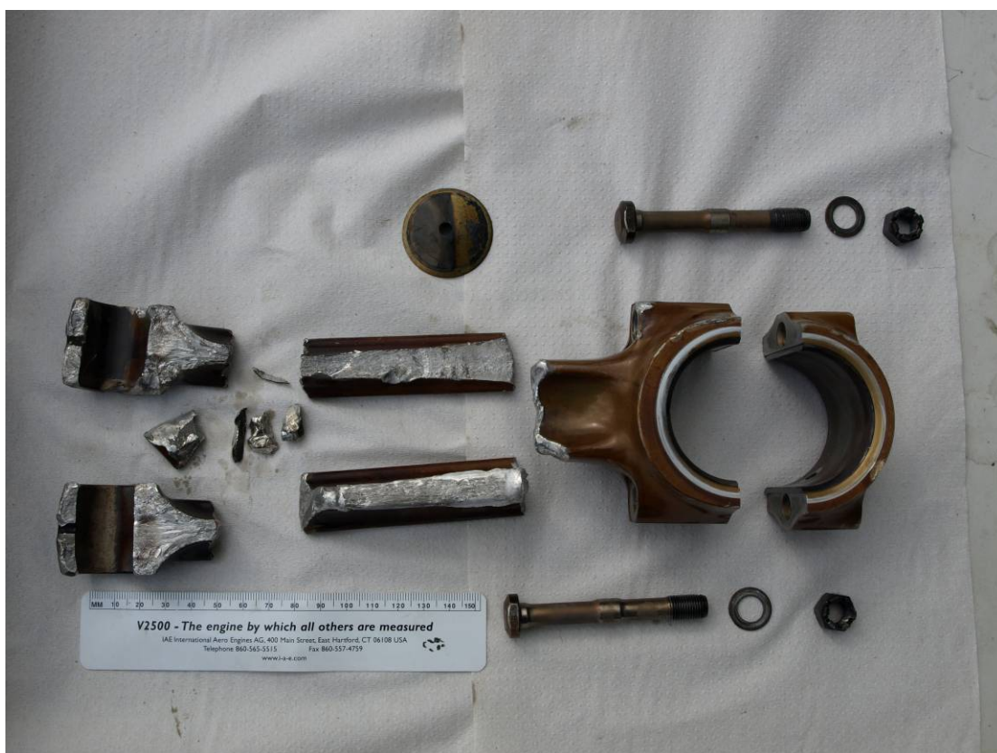
Poškozené části ojnice válce č. 6
