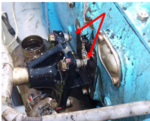
Poškození levého úchyty mot. lože
