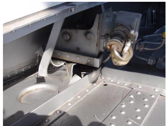
Poškození zámků hlavního podvozku
