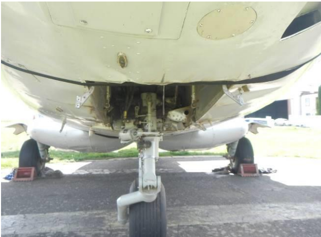
Poškození krytů a bočních stěn šachty příďového povozku a potahu gondoly hlavního podvozku
