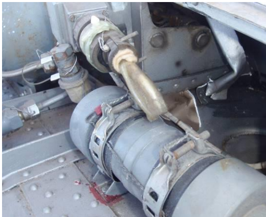
Poškození zámků hlavního podvozku
