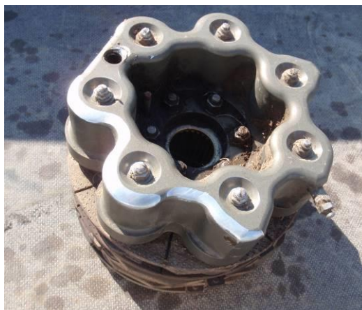
Poškození brzdy hlavního podvozku
