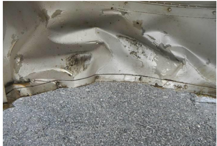
Poškození krytů a bočních stěn šachty příďového povozku a potahu gondoly hlavního podvozku
