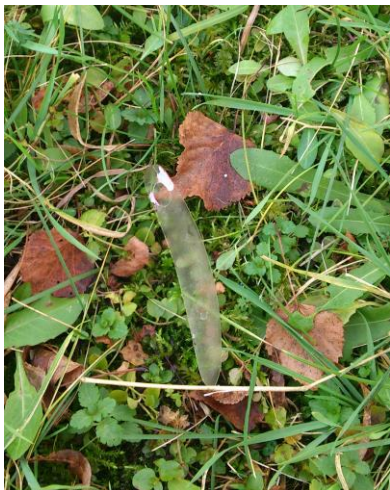
Oddělené části listu nosného rotoru č. 2 (stopa č. 2 a č. 3)
