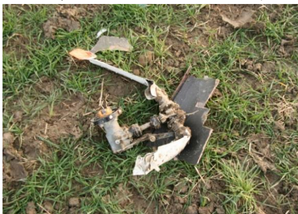
Oddělený ocasní rotor a převodovka
