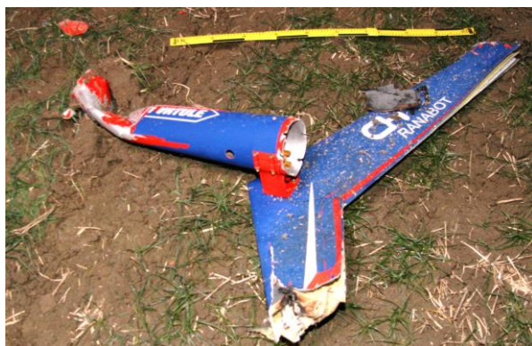
Oddělený konec ocasního nosníku a svislá ocasní plocha
