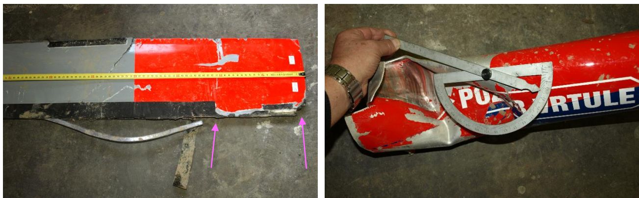
Obr. 2 Místo střetu konce listu č. 2 nosného rotoru (S/N 0138) s ocasním nosníkem
