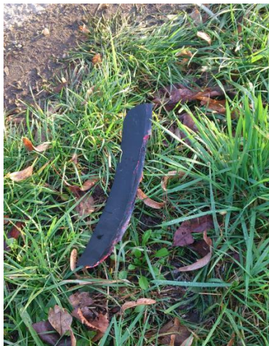
Oddělené části listu nosného rotoru č. 2 (stopa č. 2 a č. 3)
