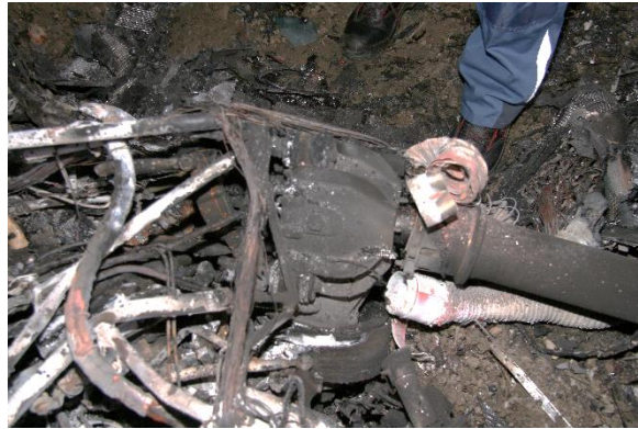
Hřídel nosného rotoru a reduktor s oscilační deskou
