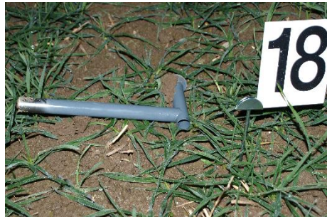
Pedály nožního řízení z levé strany kabiny
