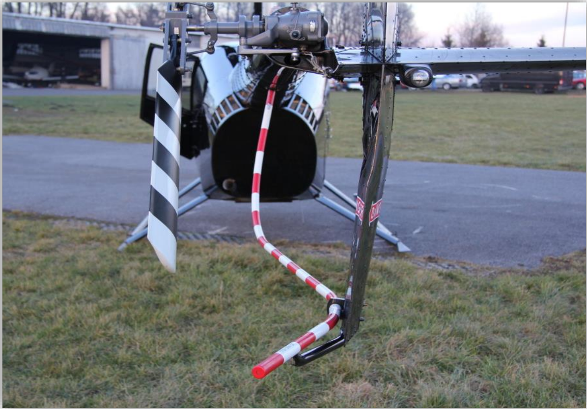
Obr. č. 1: Vrtulník R-44 po tvrdém přistání na asfaltovou plochu
