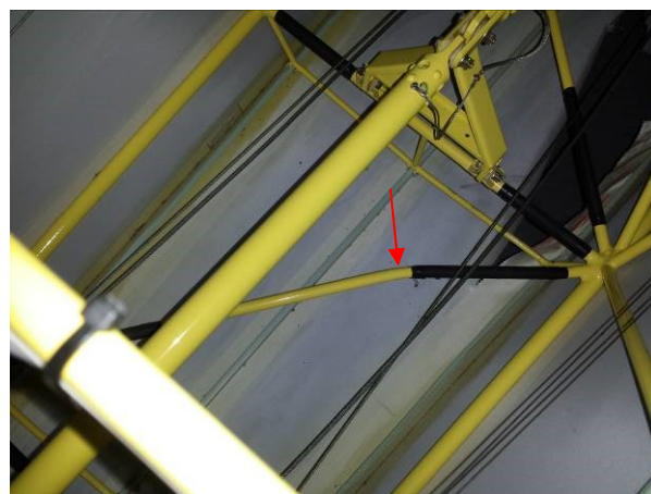
Deformace diagonály spodní roviny prutoviny trupu
