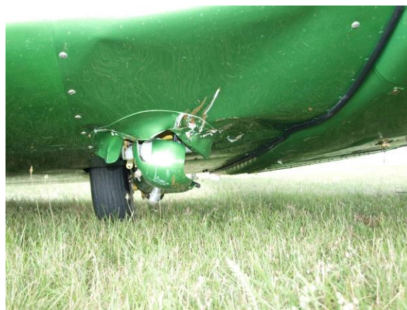
Poškození pravé poloviny křídla a krytu podvozku
