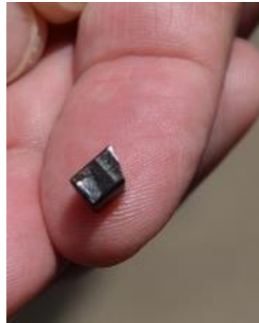
Vylomený praporek unášeče č.v. Yc-119 náhonu čerpadla
