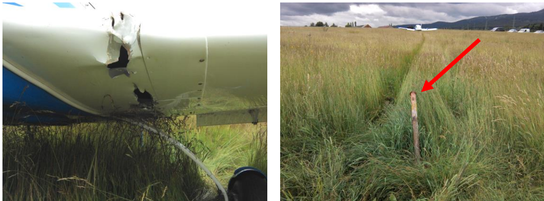
Poškození potahu křídla po přistání do terénu a ohnutý kovový kolík ve stopě po přistání.
