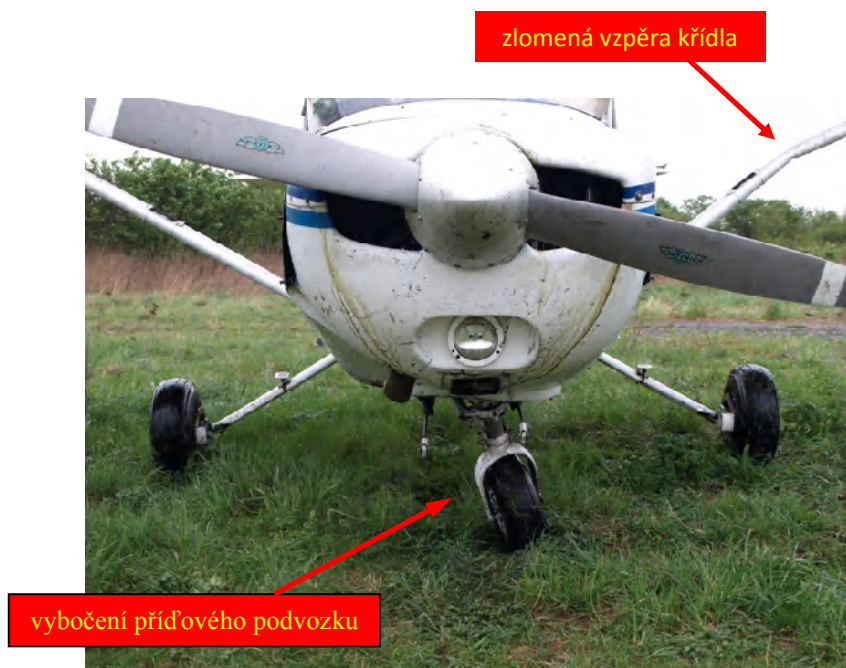
Obr. 2 Poškození letounu OK-LEV
