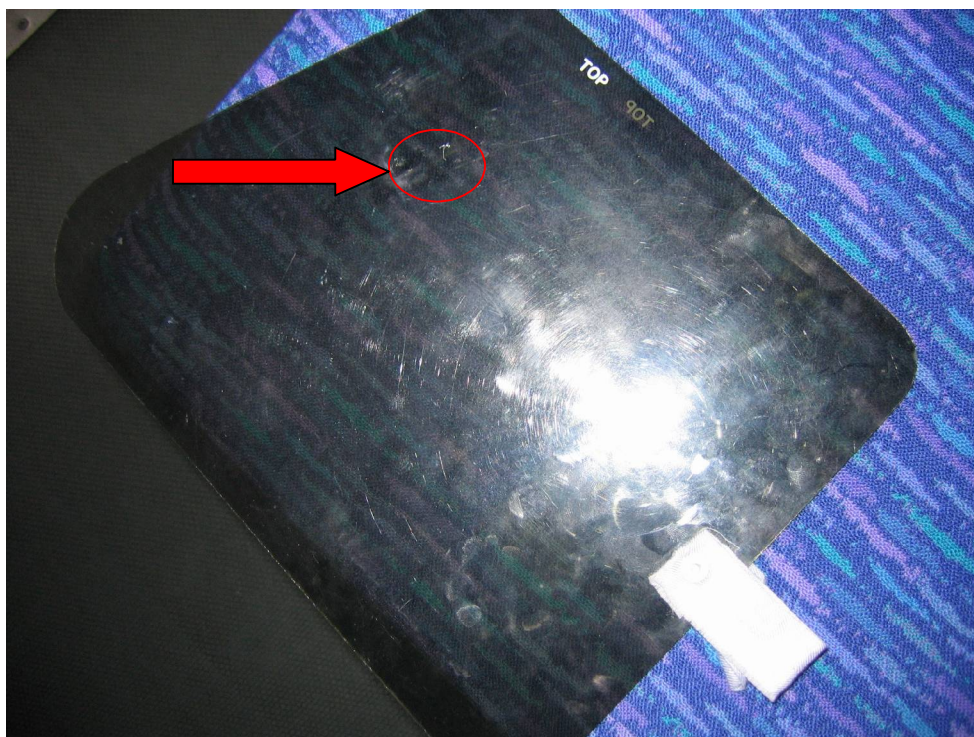
Obr. č.1 Místo tepelného poškození sluneční clony.
