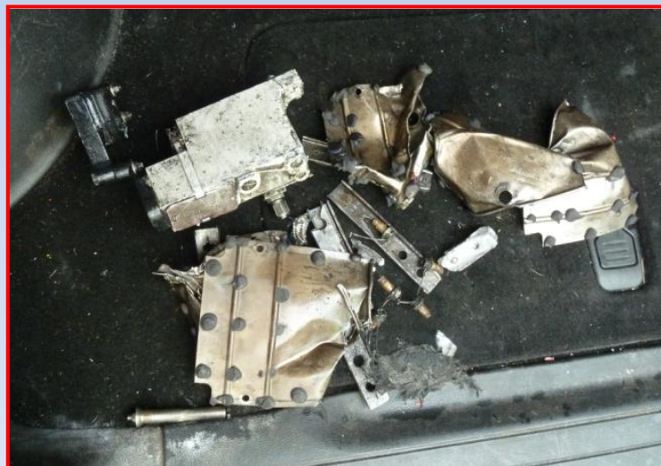
Odstavený letoun B737, detail poškozeného levého podvozku a kovové části, které zůstaly na RWY06.
