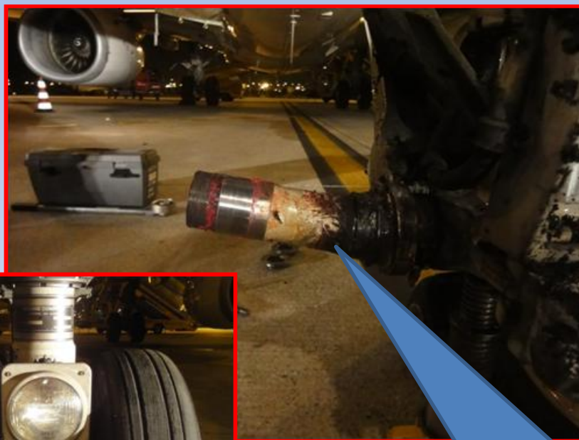
Vyhnutí osy kola předového podvozku
