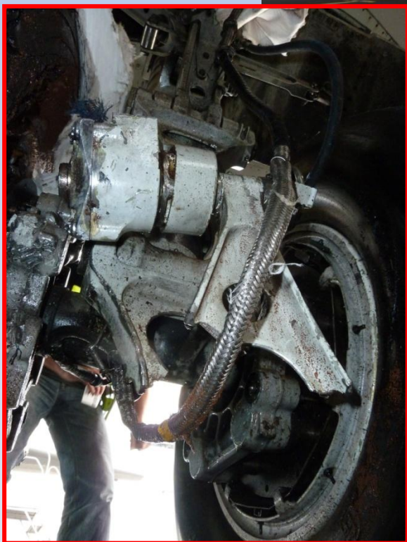
Odstavený letoun B737, detail poškozeného levého podvozku a kovové části, které zůstaly na RWY06.
