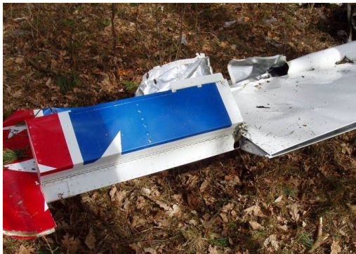
Levé křídélko po deformaci nárazem.
