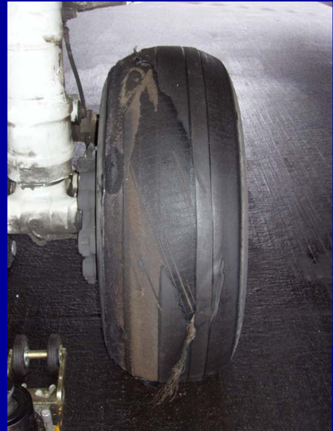
Poškozená pneumatika na pravé podvozkové noze
