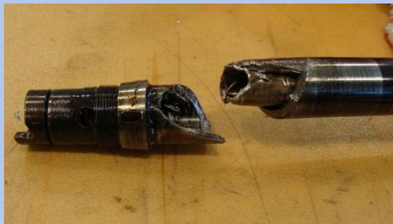
Překroucení vačkového hřídele motoru M 337A
