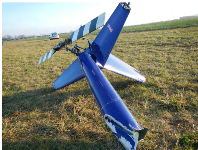
Obr. č. 3: Koncová část ocasního nosníku (A)
