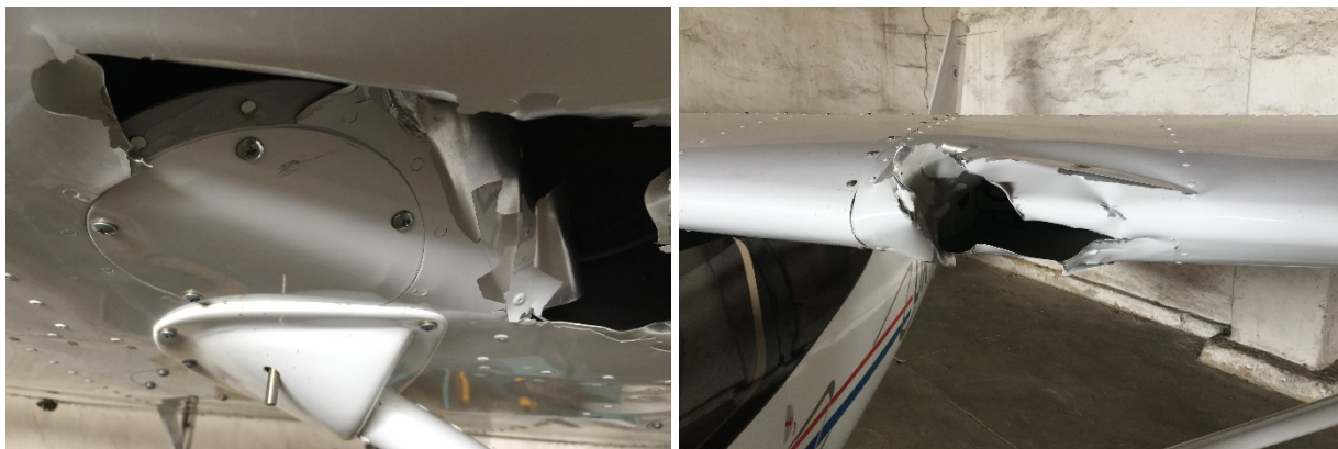
Obrázek č. 2 Pohled na poškození pravé a levé poloviny křídla.
