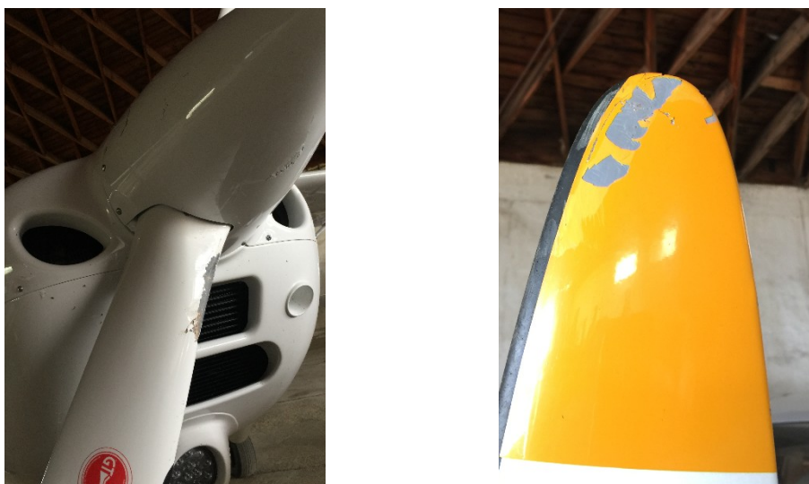
Obrázek č. 3 Pohled na poškození vrtule.
