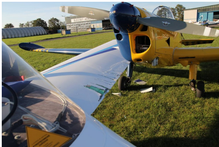
Obrázek č. 1 Stav po nárazu Z-326 MF do křídla TL-2000 Sting.
