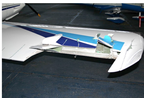
Obrázek č. 3 Rozsah poškození pravé poloviny křídla.
