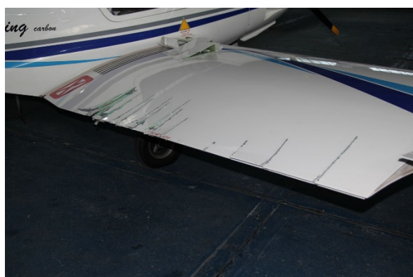
Obrázek č. 3 Rozsah poškození pravé poloviny křídla.
