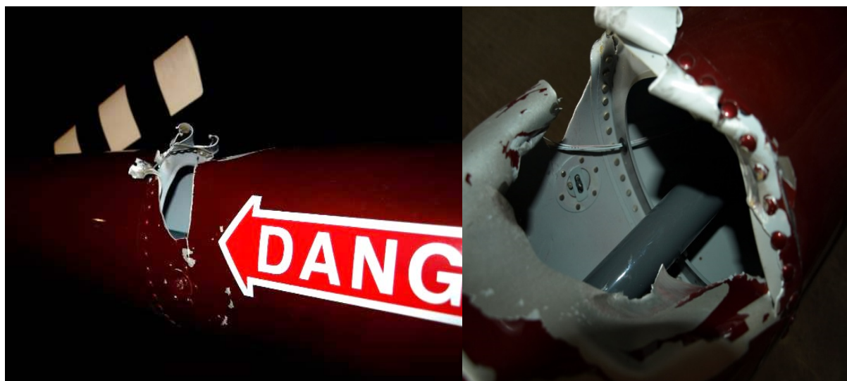
Obr. č. 1: Poškozený ocasní nosník vrtulníku R 44
