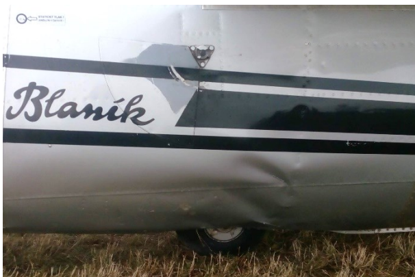
Obrázek č. 2 Poškození trupu – levá strana.
