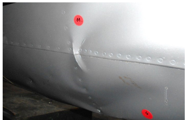
Obrázek č. 3 Poškození trupu – pravá strana.
