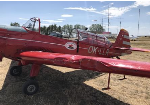
Obr. 6 a 7 - Poškození Z-226 MS, náběžná hrana levé poloviny křídla, vrtule a potah levé přední části trupu.
