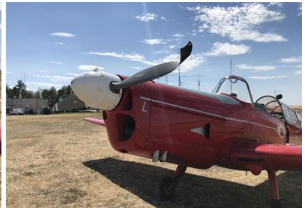
Obr. 6 a 7 - Poškození Z-226 MS, náběžná hrana levé poloviny křídla, vrtule a potah levé přední části trupu.
