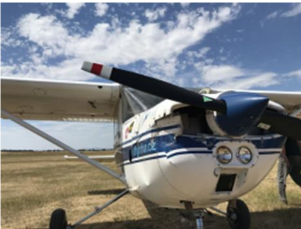
Obr. 8 - 9 Poškození C-150, náběžná hrana levé poloviny křídla, její vzpěra a motorové kryty.
