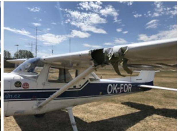
Obr. 8 - 9 Poškození C-150, náběžná hrana levé poloviny křídla, její vzpěra a motorové kryty.
