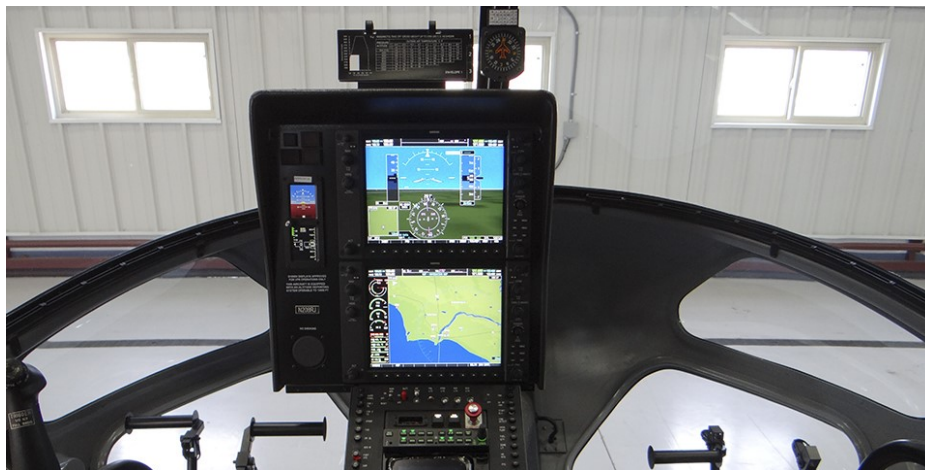
Obr. 3 – Systém Garmin G 1000H integrovaný do přístrojové desky
