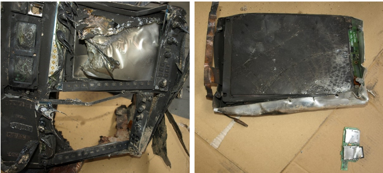
Obr. 12 - Oba MFD zničené požárem (vlevo) a MFD s dvojitým slotem pro datové karty (vpravo)
