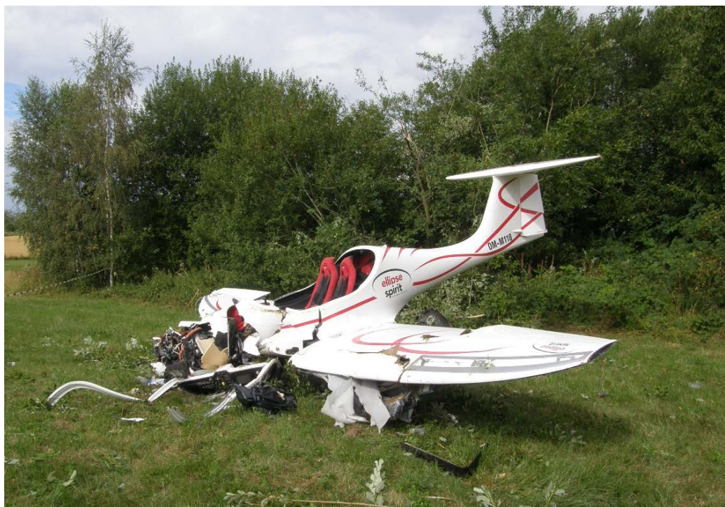
Obr. 6: Ultralehký letoun na místě dopadu po převrácení na podvozek.
