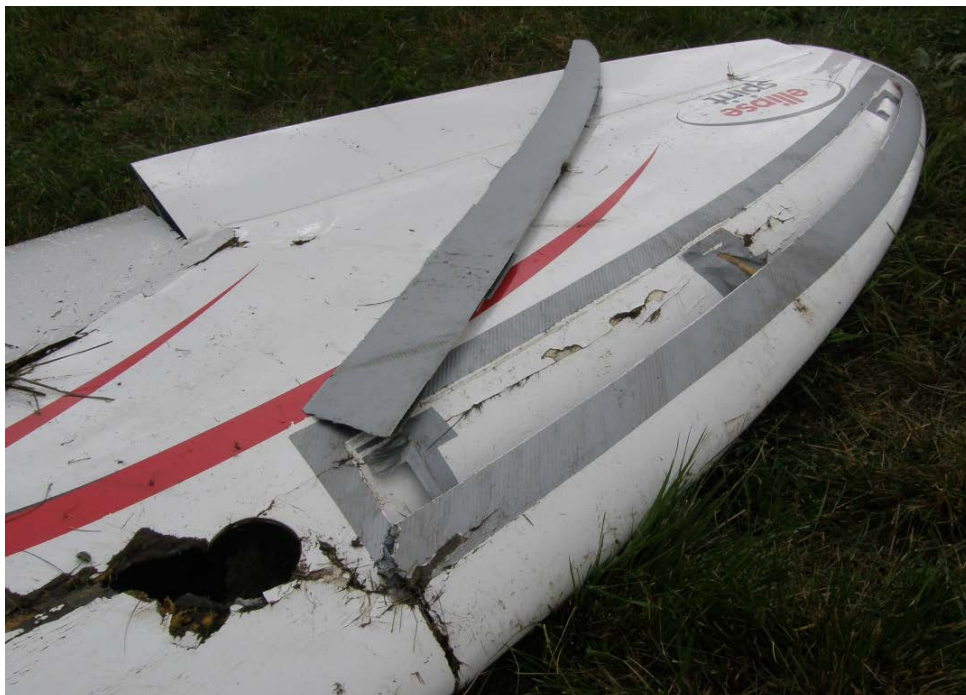
Obr. 8: Zaslepení integrovaného slotu na levé polovině křídla. Zaslepení slotů bylo provedeno kevlarovým profilovaným dílem přilepeným technickou páskou.
