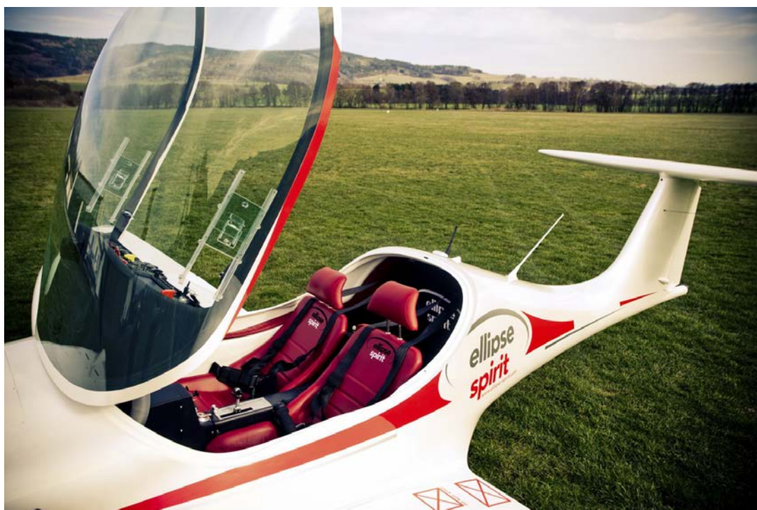
Obr. 4: Otevřený překryt ultralehkého letounu Ellipse Spirit.
