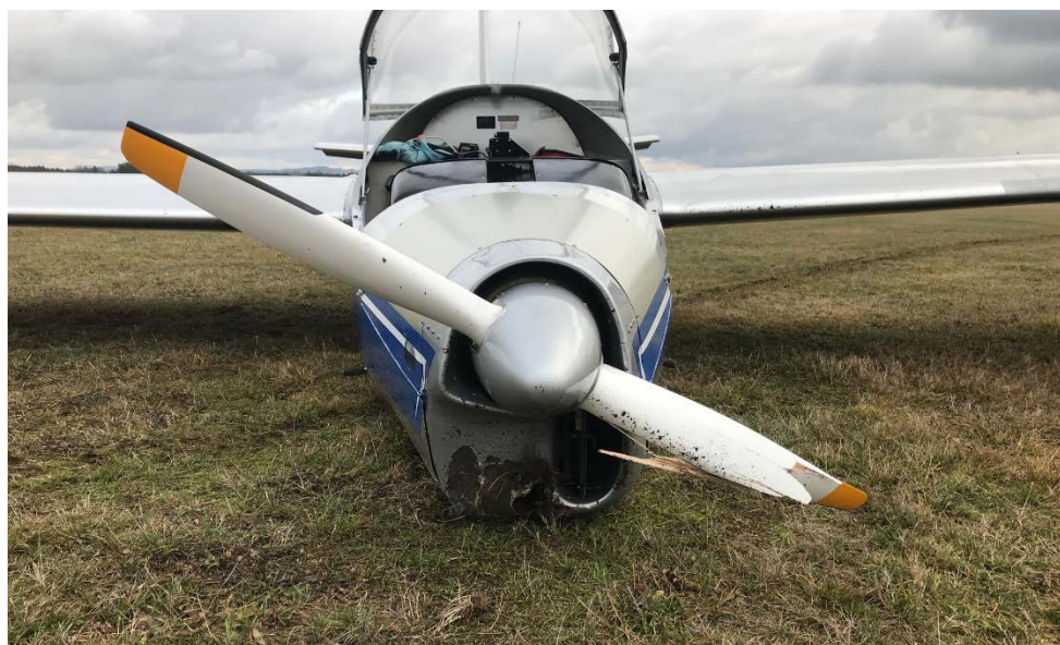
Obr. 3 – Poškození vrtule a přední části.
