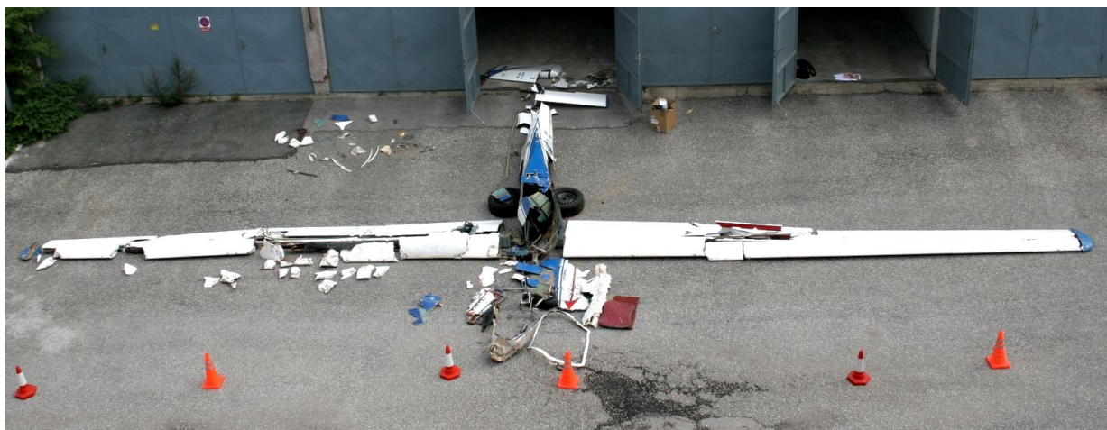
Obrázek č. 11 Rekonstrukce tvaru kluzáku OK-3405 ze zajištěných trosk.
