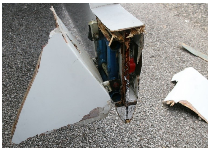
Obrázek č. 12 Místo odlomení pravé poloviny VOP v místě výkyvného lože.
