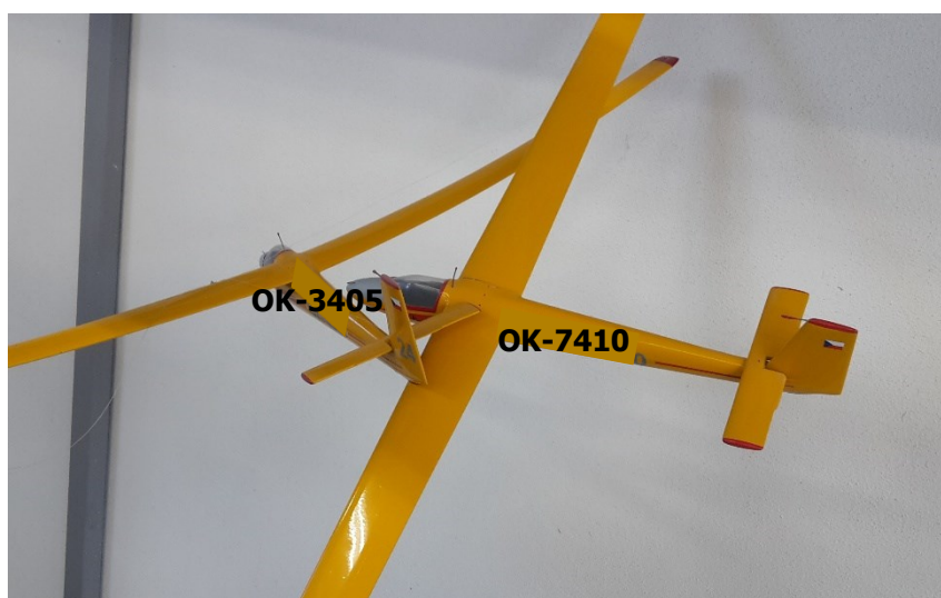
Obrázek č. 16 Rekonstrukce pravděpodobné vzájemné polohy kluzáků při střetu.
