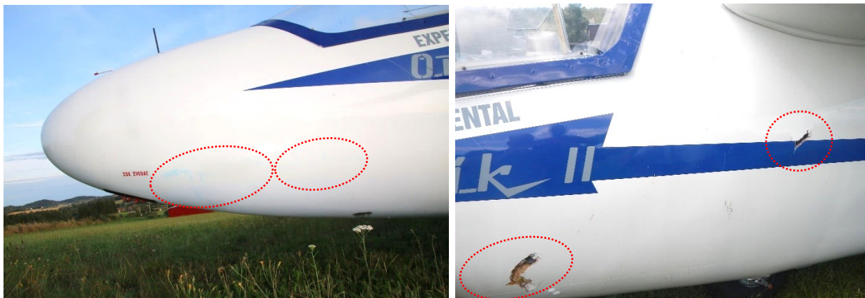
Obrázek č. 13 Otěr modré barvy na přídi. Poškození na levém boku a překrytu kabiny kluzáku OK-7410.
