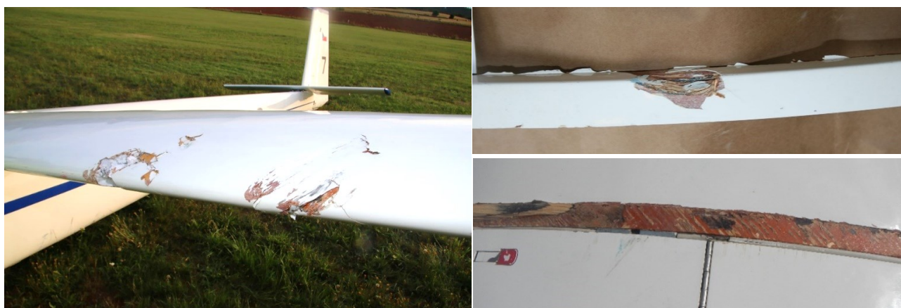
Obrázek č. 14 Poškození na náběžné části levé poloviny křídla a krycí lišty na horní straně levé poloviny křídla kluzáku OK-7410 se stopou nárazu oblého předmětu modré barvy.
