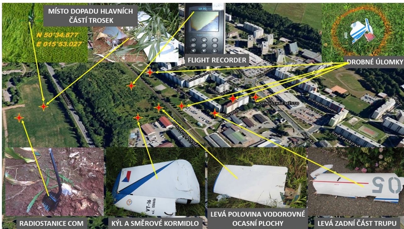
Obrázek č. 10 Místa nálezu podstatných částí trosek kluzáku OK-3405.
