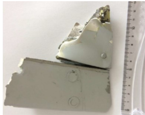
Obrázek 5 – Poškození okraje stabilizátoru letounu N277EA
