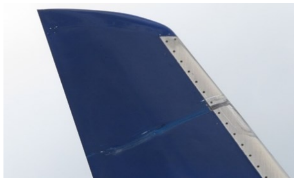
Obrázek 6 – Poškození okraje wingletu na letounu OK-TVW
