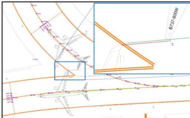
Obrázek 9 – Odvozená trajektorie pohybu okraje wingletu OK -TVW při kolizi se stabilizátorem N277EA.
