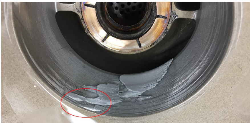
Obr. 10 Stopy nataveného kovu ve skříně čerpadla.
